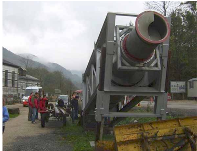
Bild 4: Pilotanlage der Albrecht'schen Wasserkraftschnecke
